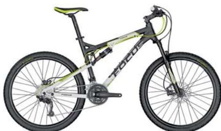
Это тот же кросс-кантри хардтейл, но дополнительно оснащен задним амортизатором.
